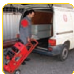
Posizionare la parte alta del carrello sulla soglia del veicolo.
